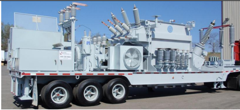
40 MVA 115Y x 69Y - 69Y x 34.5Y - 12 ABB
